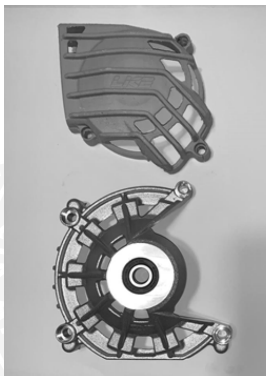
Photo du protège-chaîne et du couvercle d'allumage Photo of the chain guard and ignition cover
